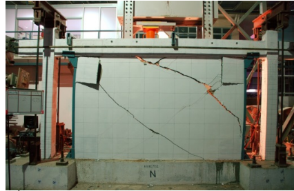
รูปที่ 2 ลักษณะความเสียหายของตัวอย่างทดสอบ MIRCFO2 [7]
