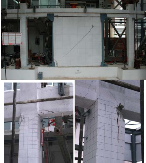
รูปที่ 11 ความเสียหายของตัวอย่างทดสอบที่ระยะการเคลื่อนตัวด้านข้างร้อยละ 2 ของความสูง
