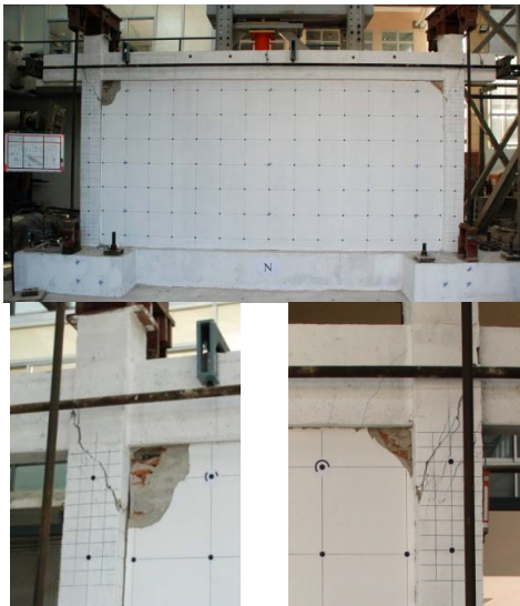
รูปที่ 1 ลักษณะความเสียหายของตัวอย่างทดสอบ MIRCFO1 [7]
